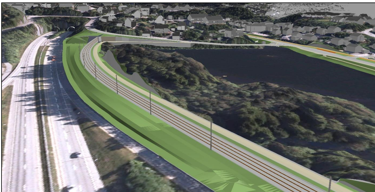
Figur 7-11: Oversiktsperspektiv av E39 i øst og Bybanen i vest over Stemhøyen, sett fra nord. Viser inngrepet banen gir i grøntarealene mellom E39 og Griggastemma.
