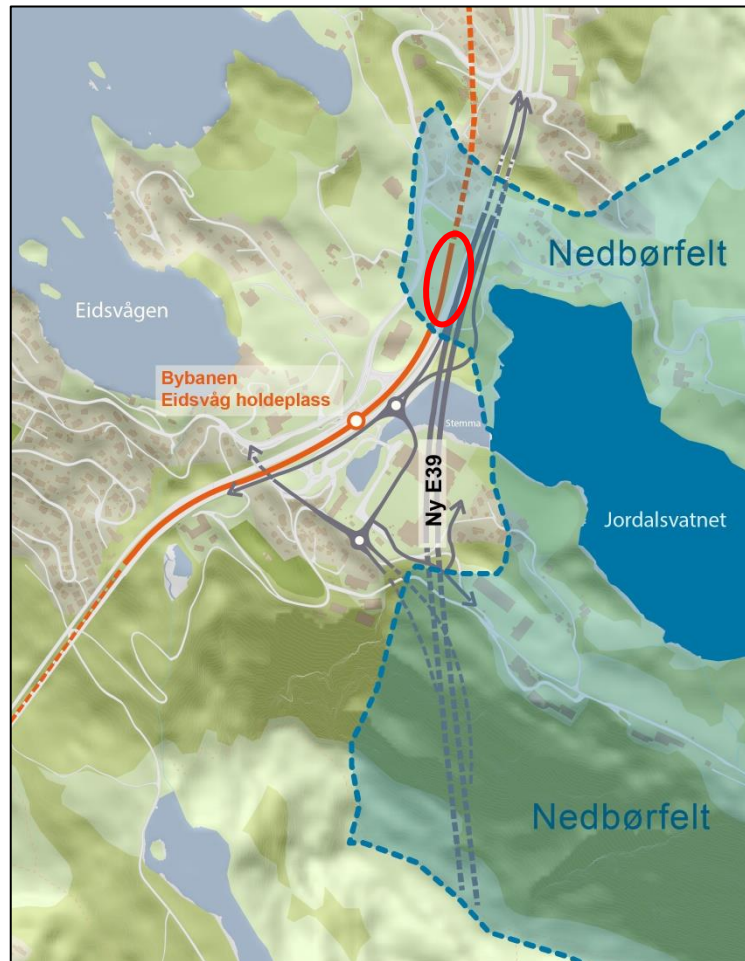
Figur 6-40: Vegsystem og bybanen sett opp mot nedbørsfeltet for drikkevannet Jordalsvatnet. Bane med oransje, veg med grått. Rød sirkel viser omtrentlig område for rigg og anleggsområde
